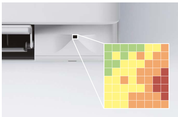
Grid Eye Sensor misura la temperatura delle superfici della stanza dividendola in 64 diversi settori.
